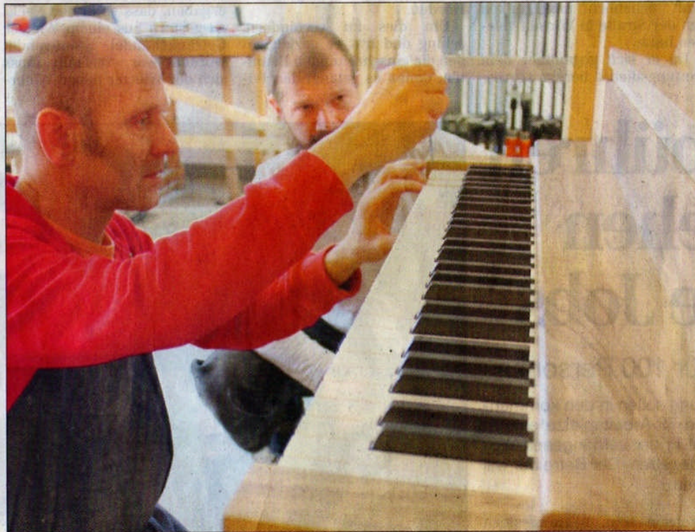
Uwe Feopentow (links) überprüft die Genauigkeit der Orgeltasten.
